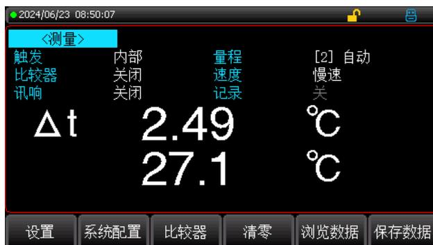
温度校正：可以补偿由于温度造成的被测值偏移，将当前环境温度下测试所得到的电阻值转化到用户设定温度的电阻值。
