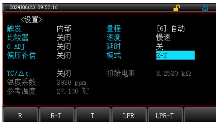
R/R-T/T/LPR/LPR-T 五种模式可选，LPR 是低电压测试模式，可以有效保护被测件
